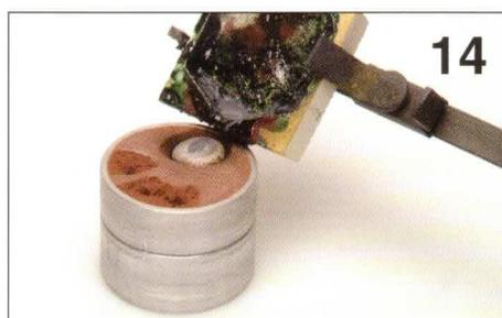
14. Mettant en fusion le métal, c'est possible de mettre le creuset sur l'anneau, à travers quoi c'est facile de verser le métal dans l'entonnoir.
