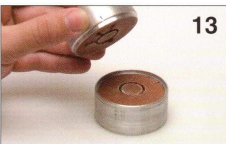
13. Remplacez les deux parties du moule l'une sur l'autre. Placez les entailles au bon endroit. Le moule est prêt à verser.
